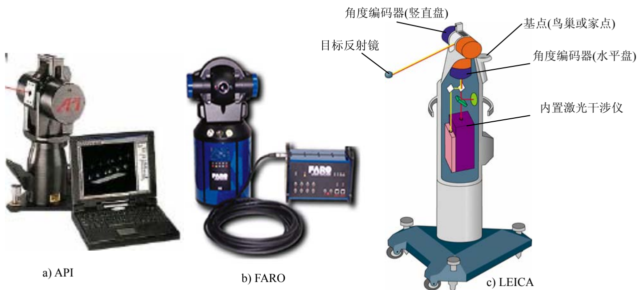
图1 激光跟踪仪结构简图
